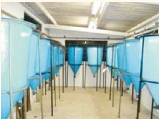
Figura 46 - Detalhes da bateria de incubadoras com sistema de recirculação de água instalada no Laboratório de Digestibilidade de Peixes na Estação de Piscicultura da Universidade Federal de Lavras – MG
