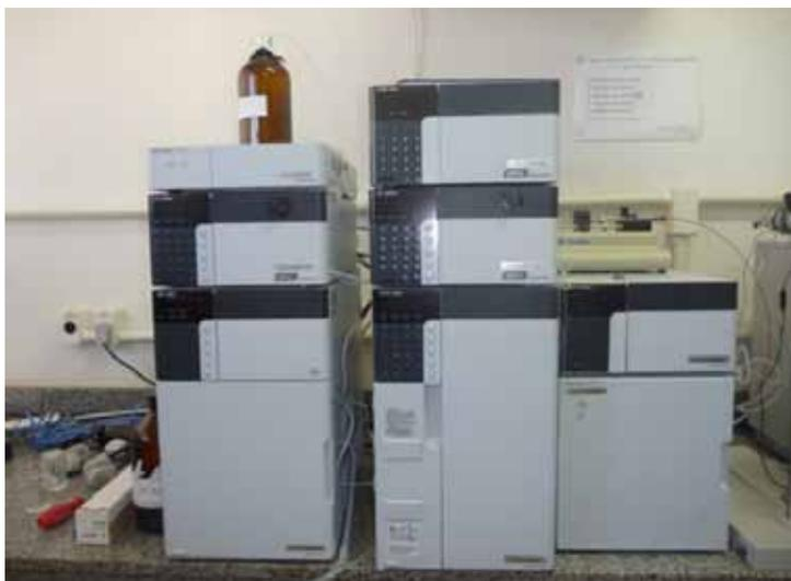
Figura 67 - Sistema de cromatografia líquida de alta eficiência
