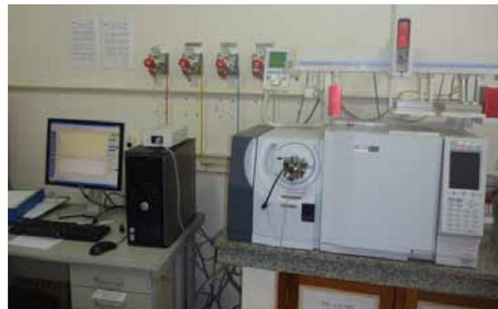
Figura 65 - Sistema de análise por cromatografia em fase gasosa associada a espectrometria de massas
