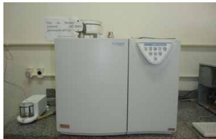
Figura 66 - Sistema analisador de Carbono, hidrogênio e nitrogênio
