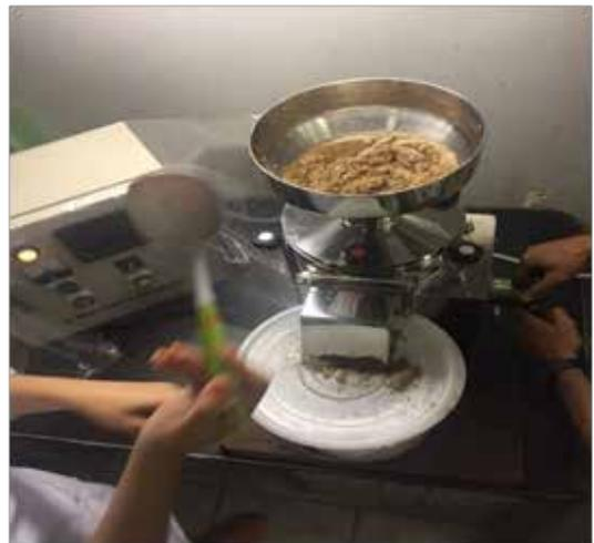
**Figura 22** - Equipamento usado para produção das nanofibras
