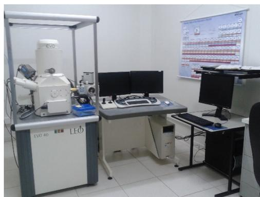
Microscópio eletrônico de varredura
