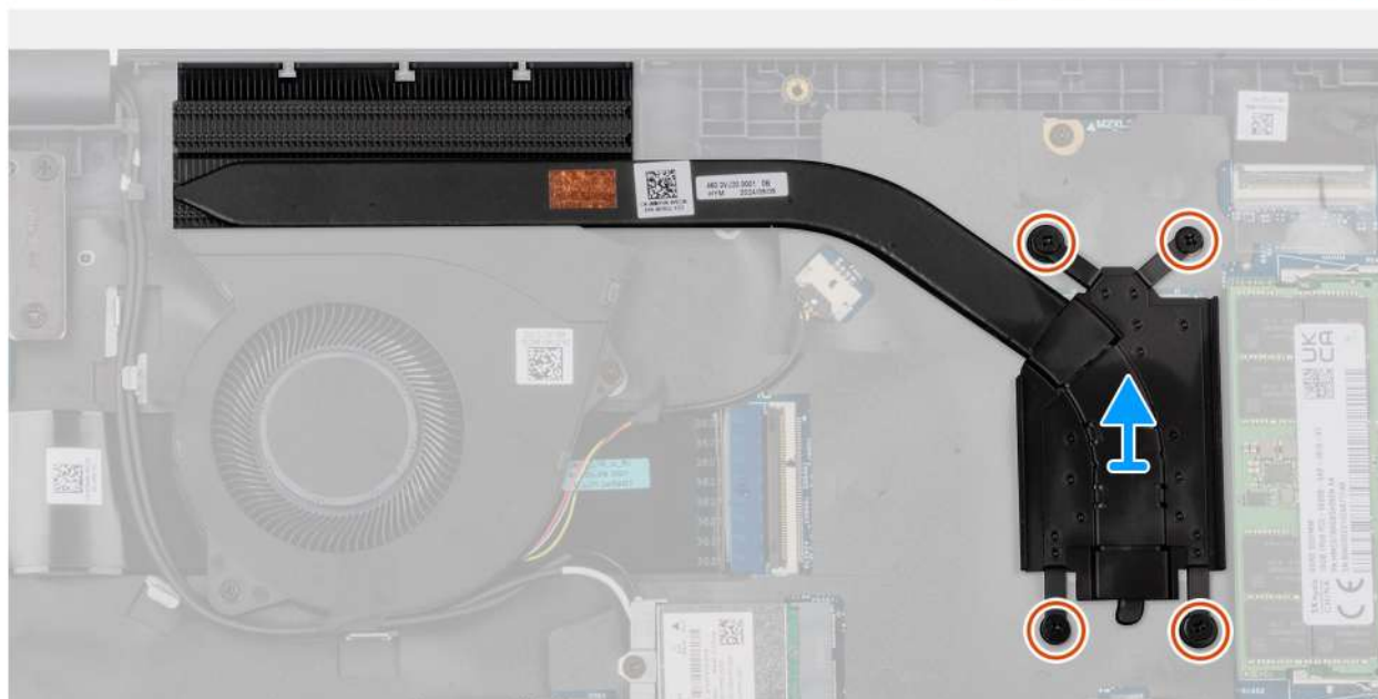
Figura43. Retirar o dissipador de calor
