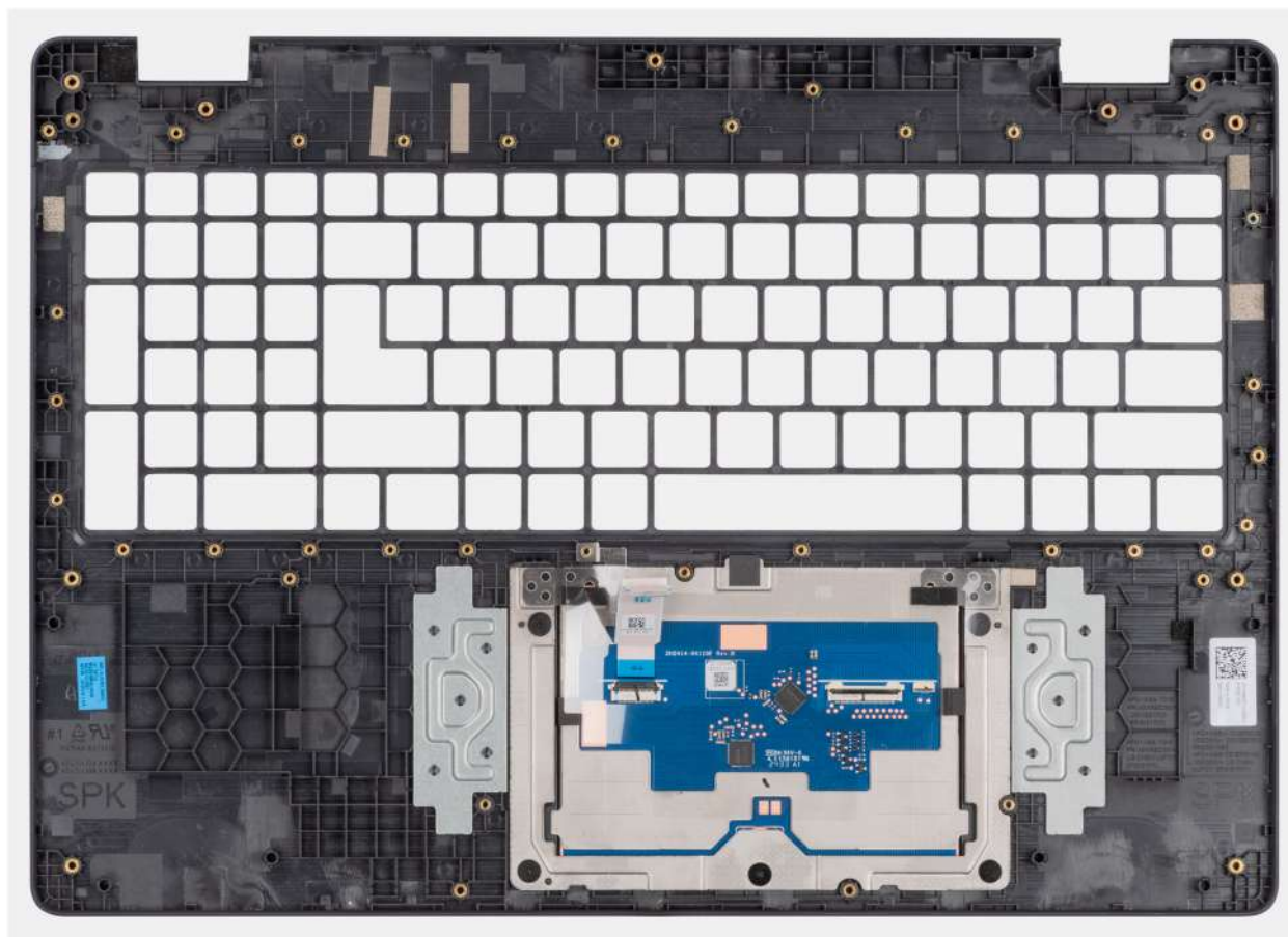
Figura90. Instalar o conjunto do descanso para os pulsos
