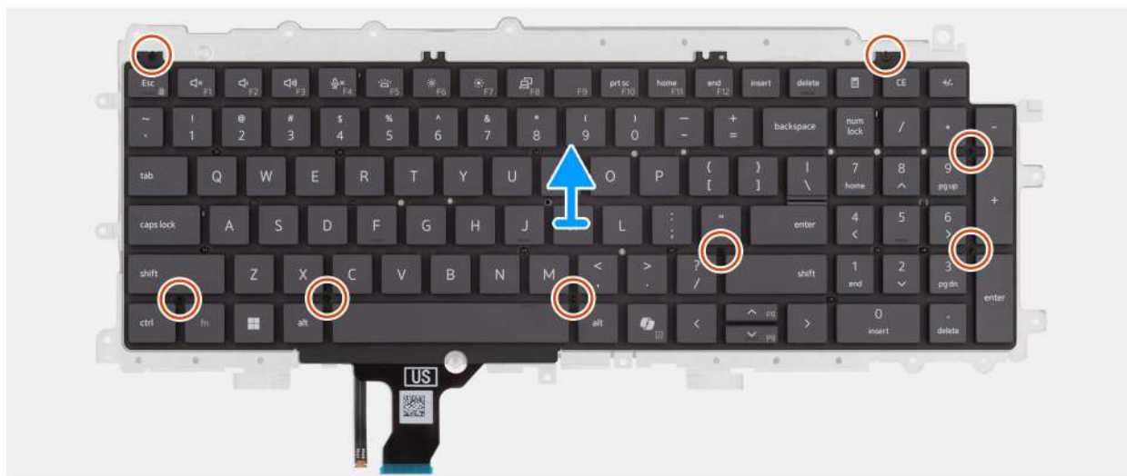
Figura85. Retirar a placa de suporte do teclado
