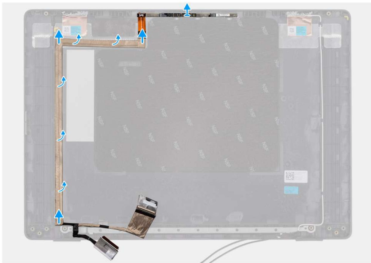
Figura115. Remoção do cabo eDP
