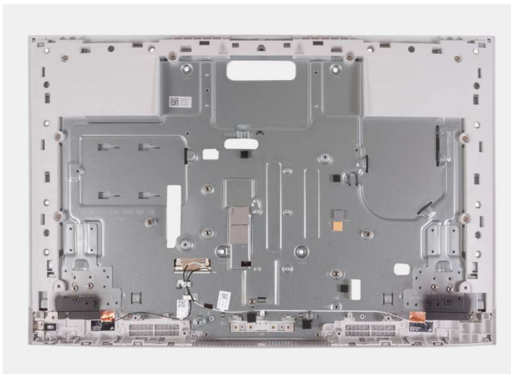
Figura66. Instalar o conjunto da armação intermédia
