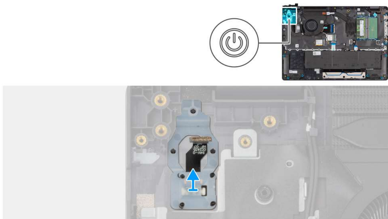
Figura55. Retirar o botão de alimentação com leitor de impressões digitais
