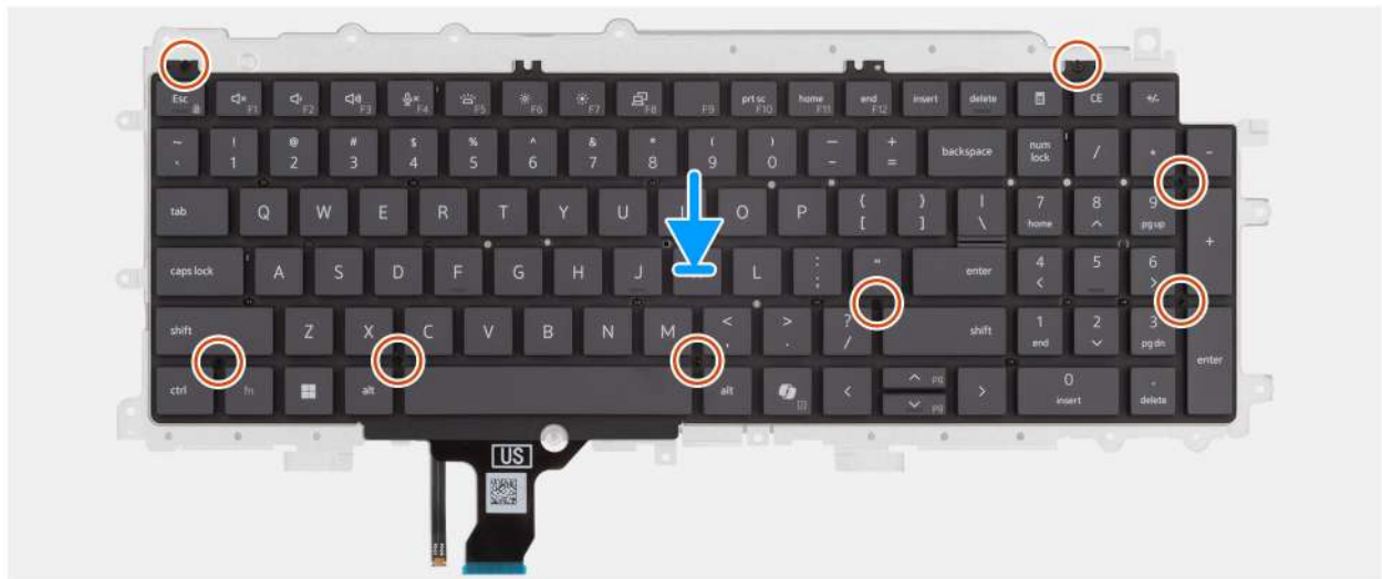
Figura88. Instalar a placa de suporte do teclado
