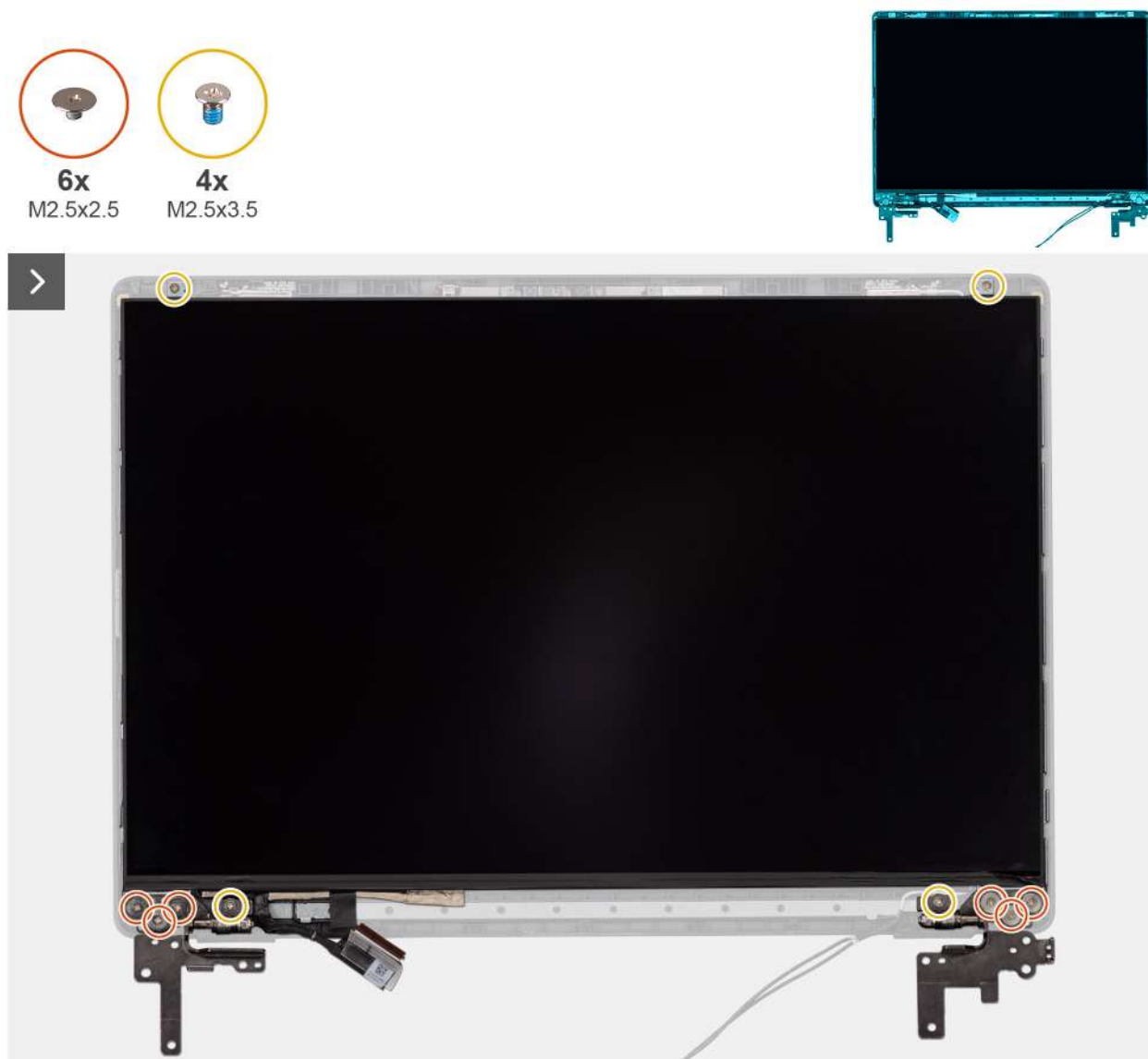
Figura105. Remoção do conjunto do painel do ecrã
