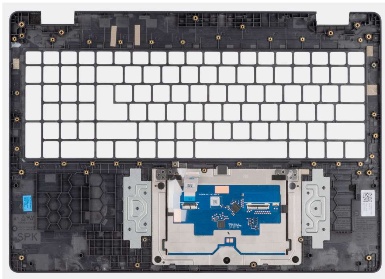
Figura89. Retirar o conjunto do descanso para os pulsos
