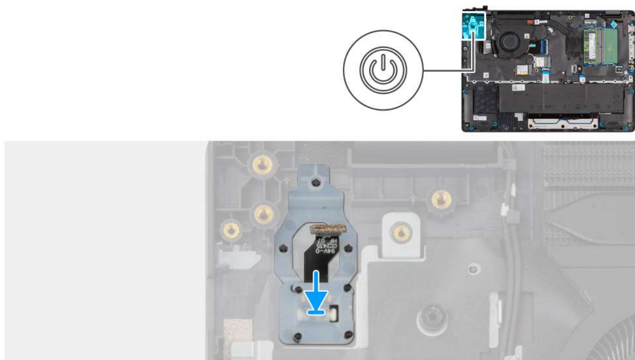
Figura56. Instalar o botão de alimentação com um leitor de impressões digitais
