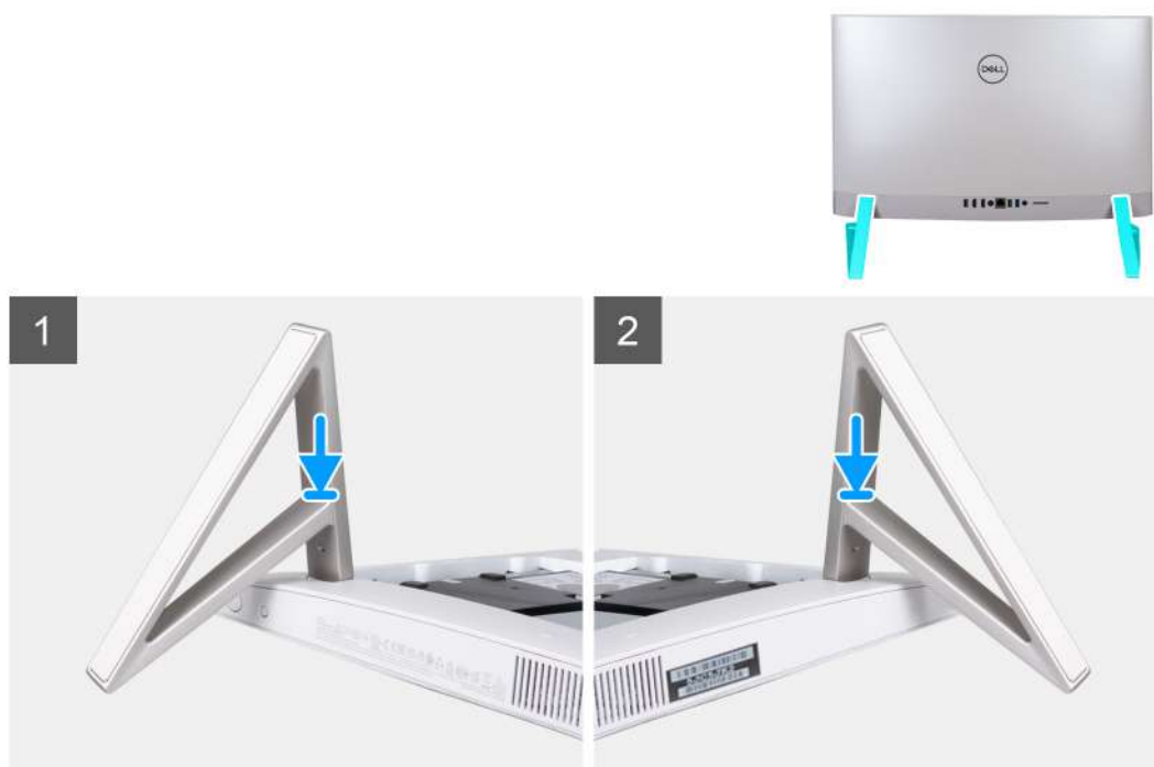
Figura19. Instalar o suporte
