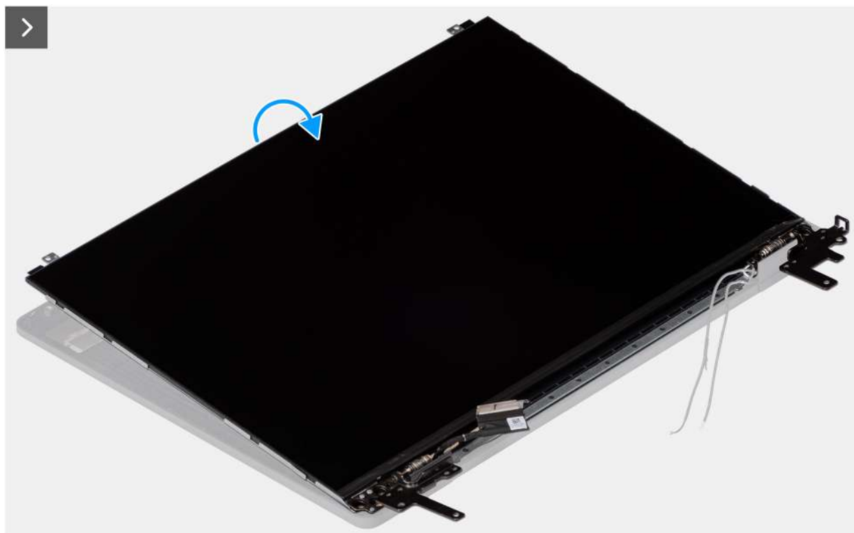
Figura106. Remoção do conjunto do painel do ecrã
