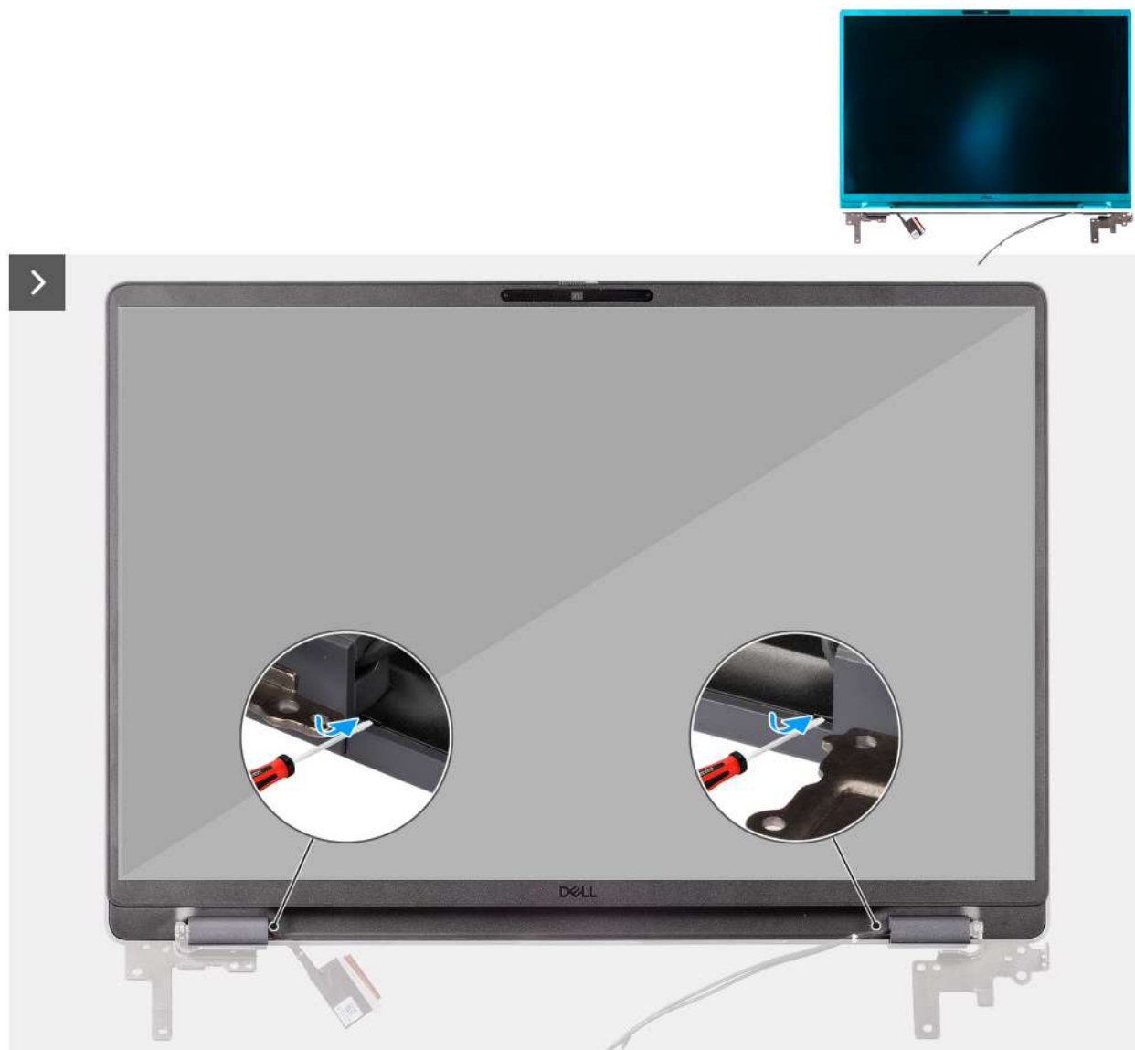
Figura98. Retirar a moldura do ecrã
