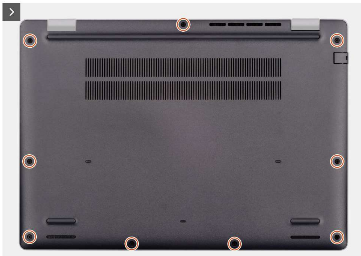
Figura11. Retirar a tampa da base
