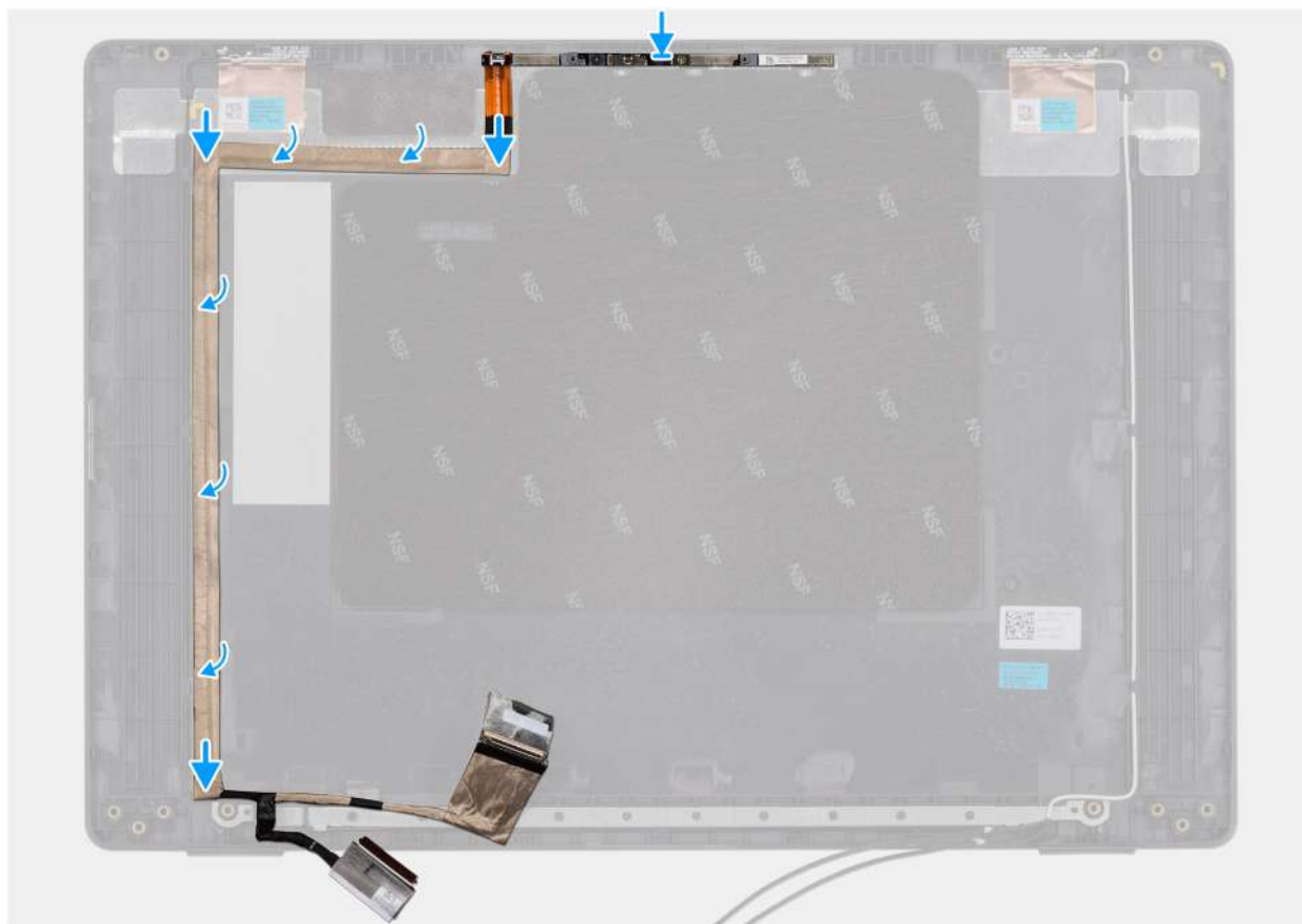
Figura116. Instalar o cabo eDP
