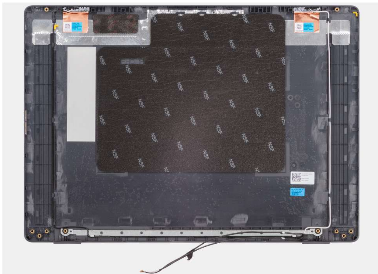
Figura118. Instalar o conjunto da tampa traseira do ecrã
