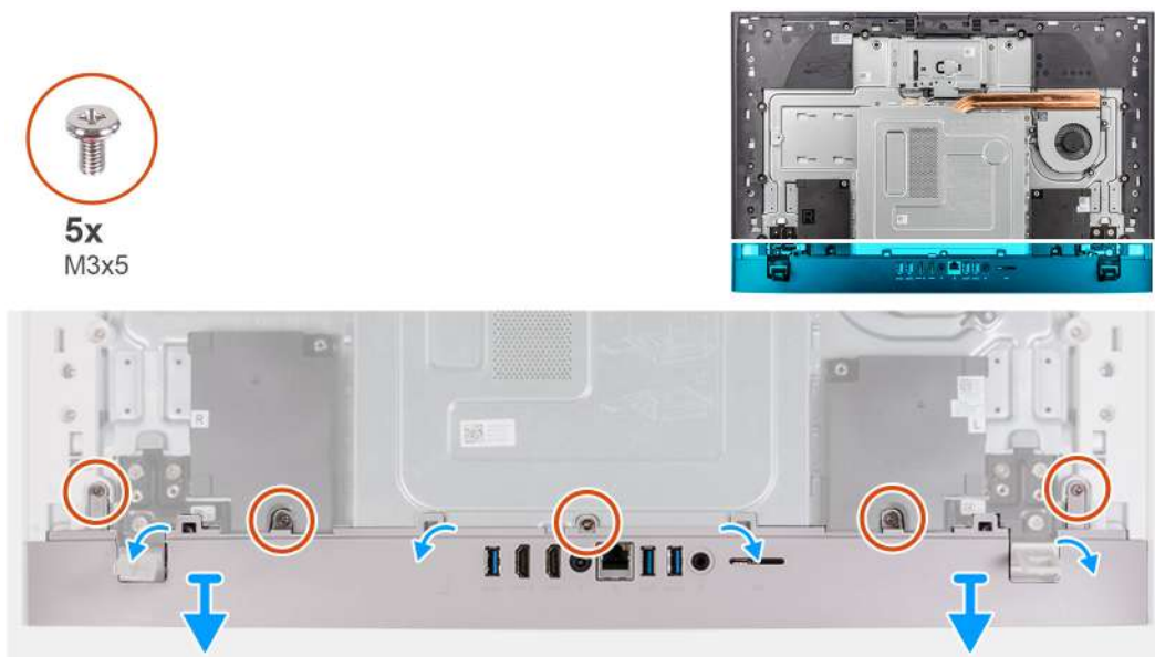
Figura23. Retirar a tampa de E/S
