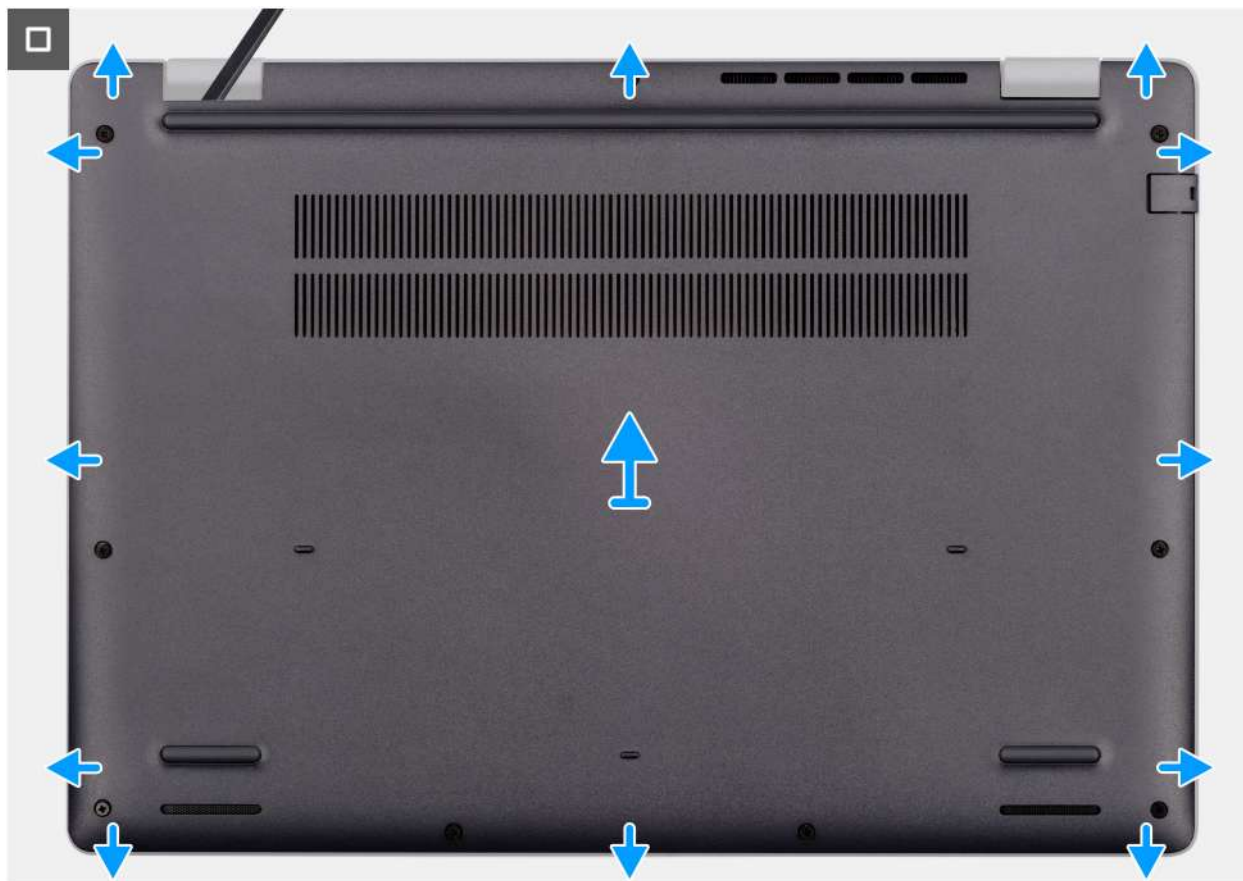
Figura12. Retirar a tampa da base
