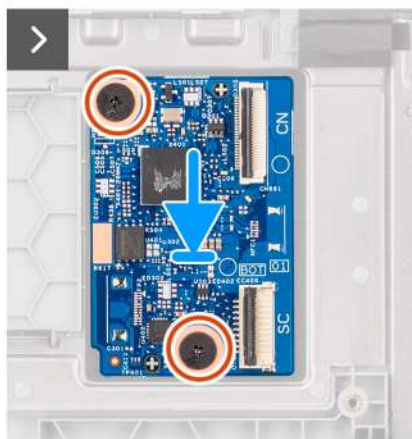
Figura38. Instalar a placa de USH
