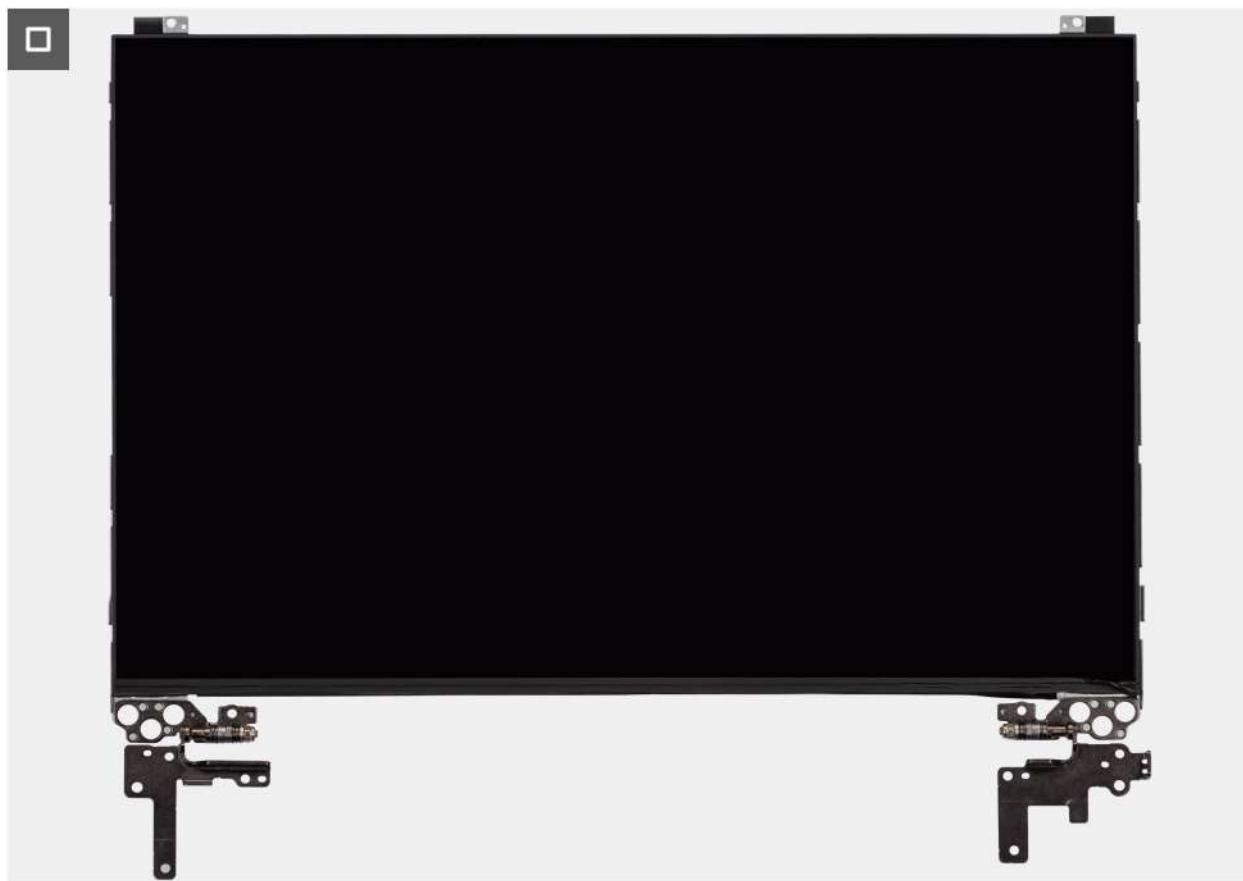
Figura108. Remoção do conjunto do painel do ecrã
