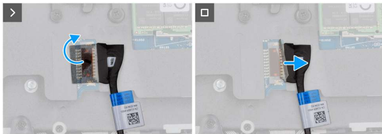
Figura13. Desligar o cabo da bateria
