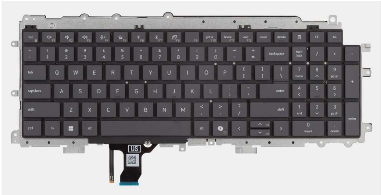
Figura82. Instalar o teclado
