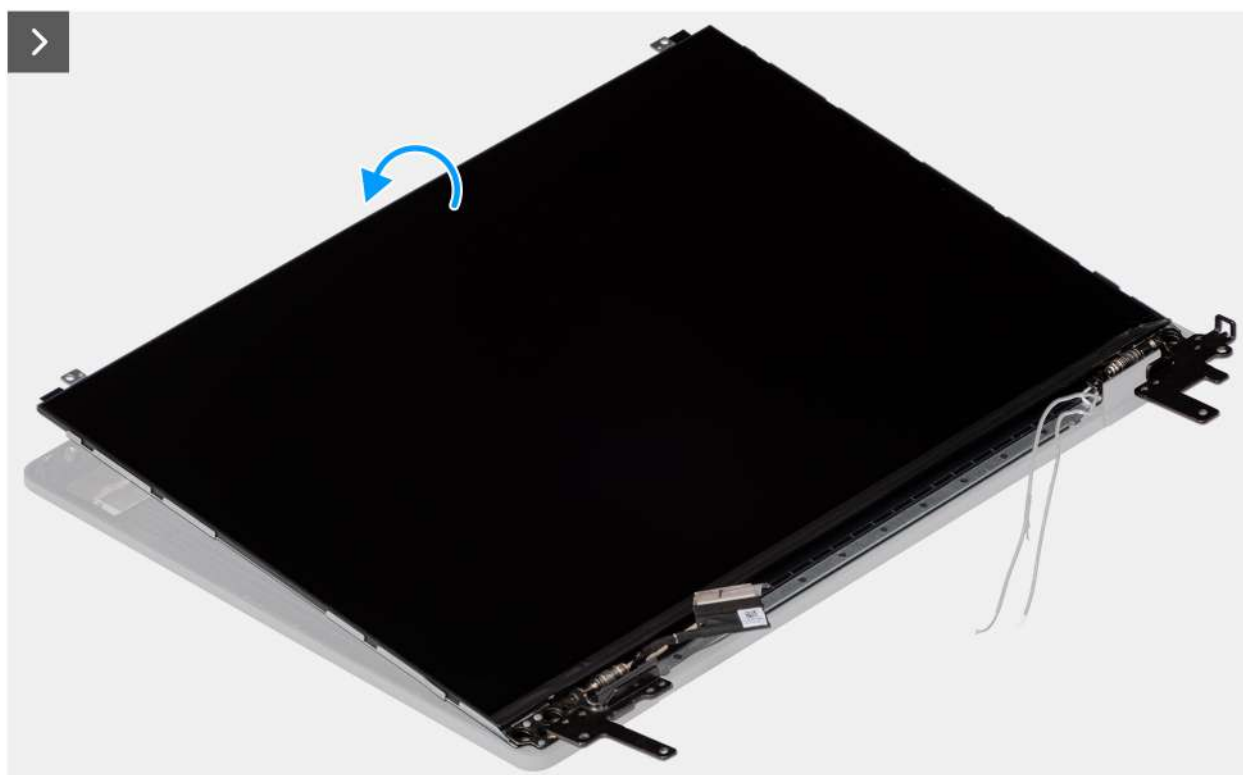
Figura111. Instalar o conjunto do painel do ecrã
