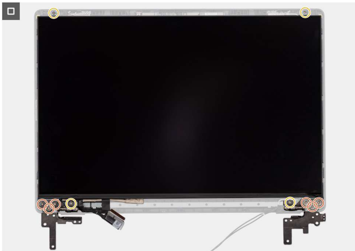
Figura112. Instalar o conjunto do painel do ecrã
