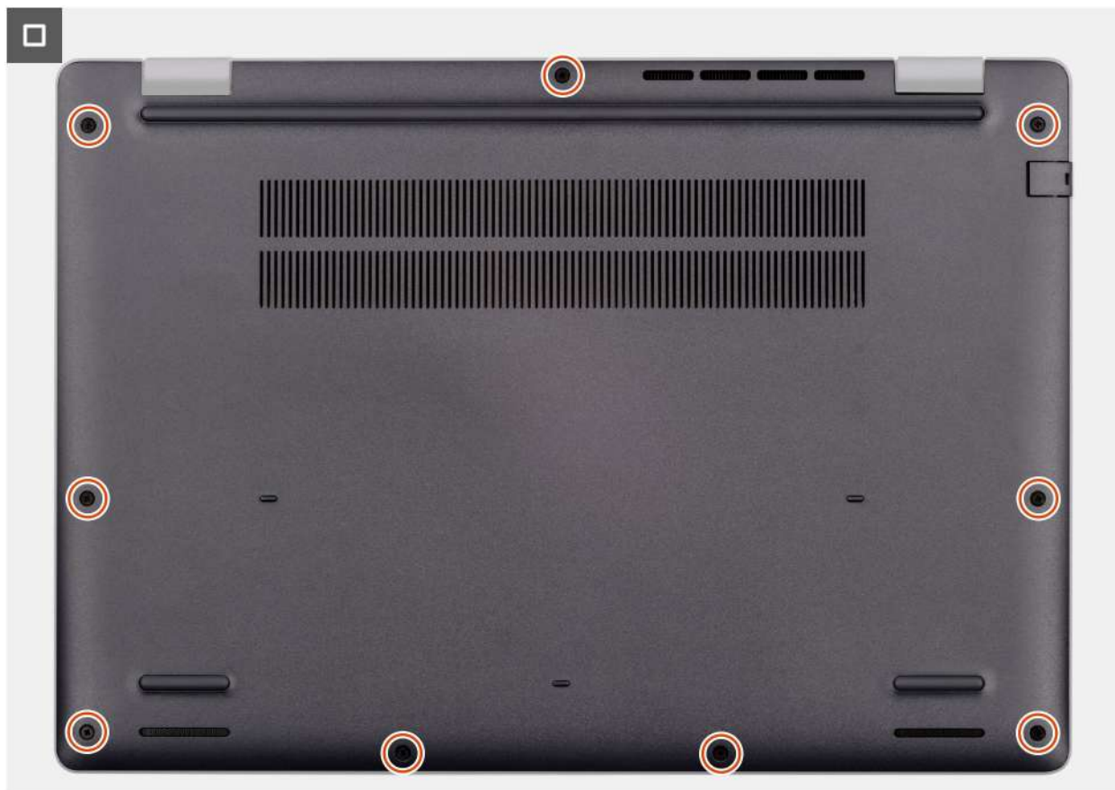
Figura 16. Instalar a tampa da base
