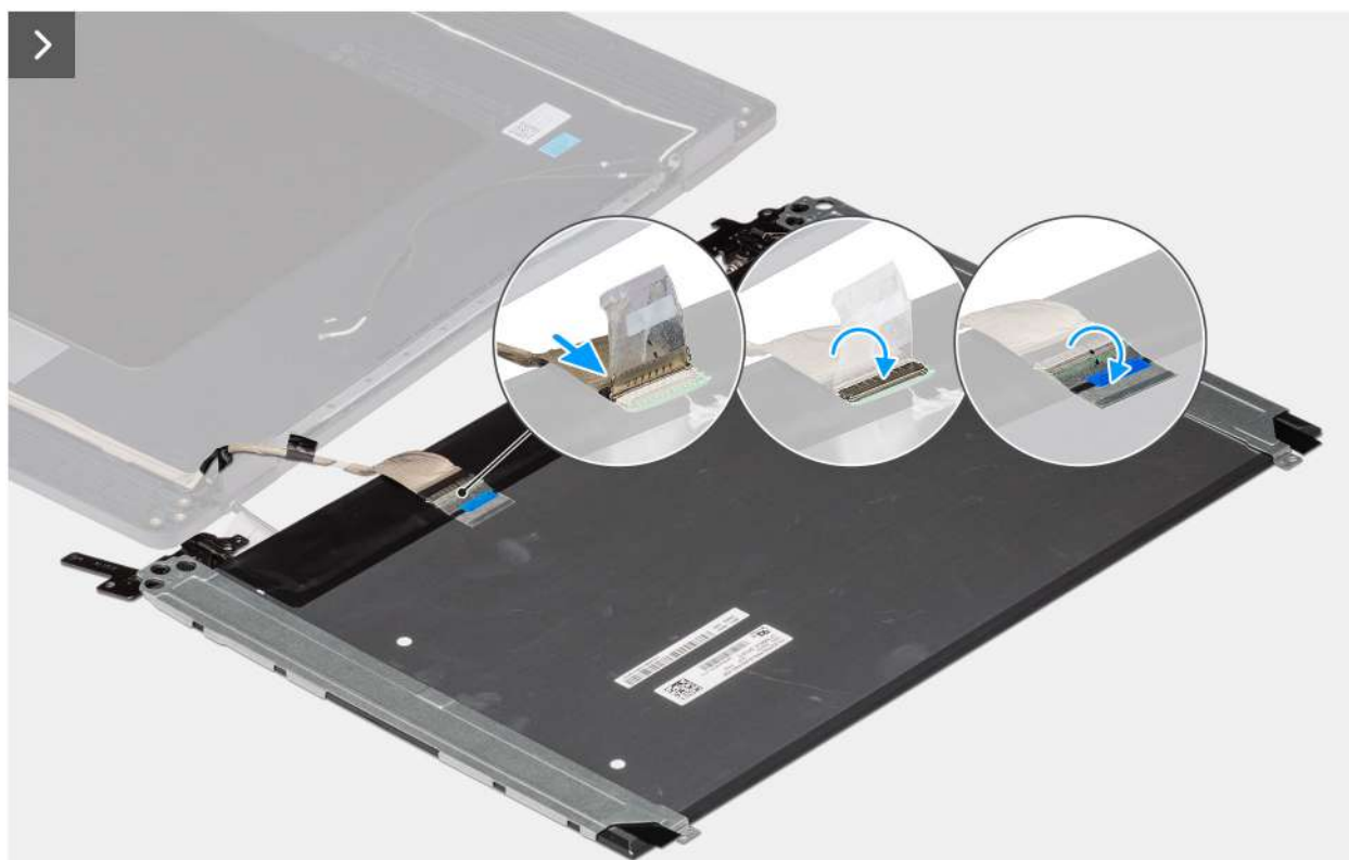
Figura110. Instalar o conjunto do painel do ecrã
