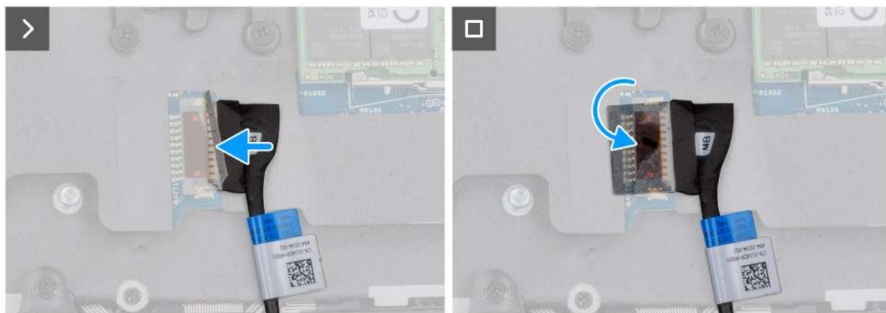
Figura14. Ligar o cabo da bateria
