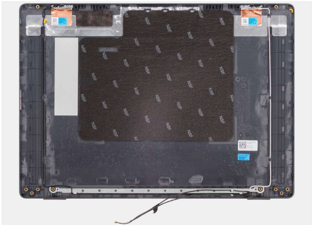
Figura117. Retirar o conjunto da tampa traseira do ecrã
