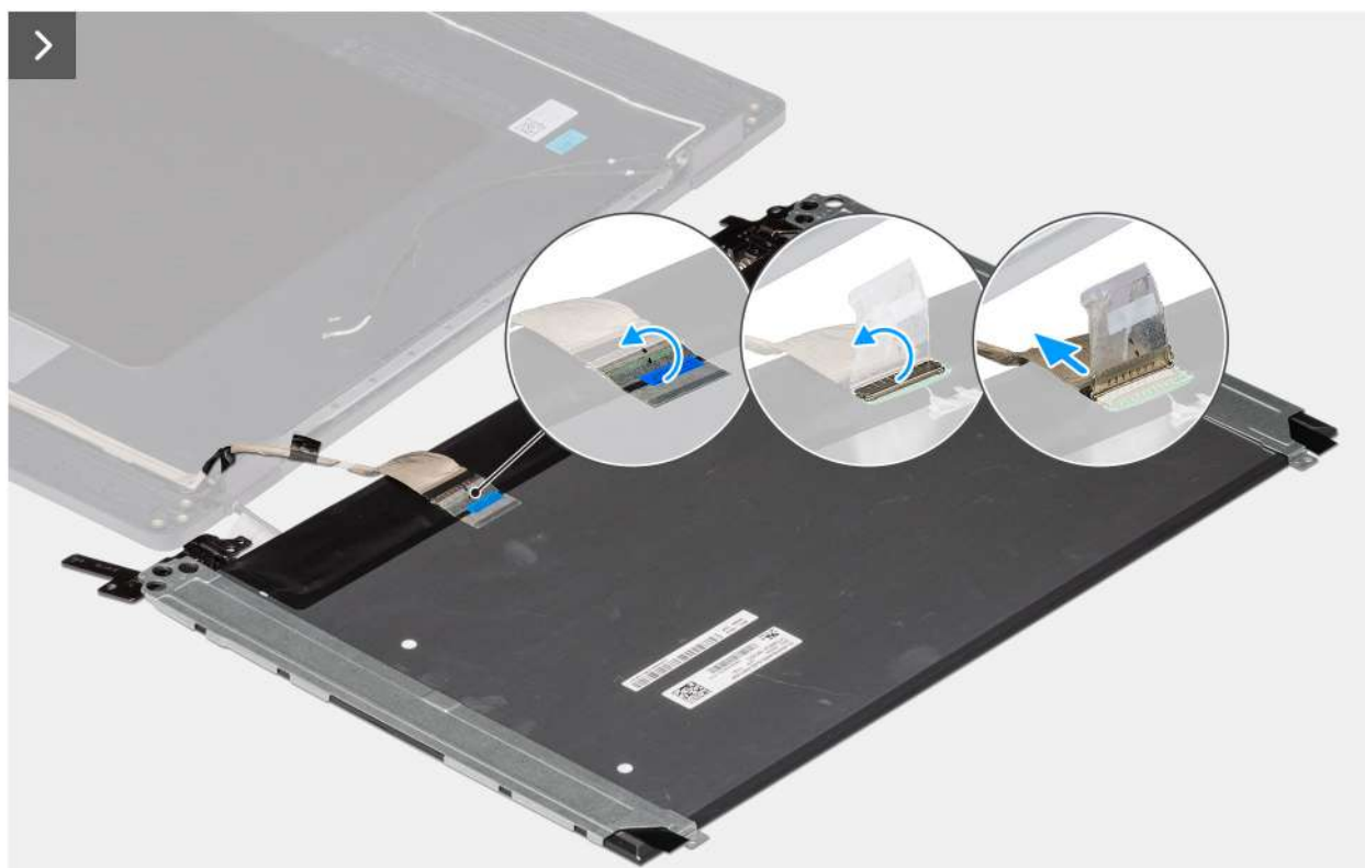
Figura107. Remoção do conjunto do painel do ecrã
