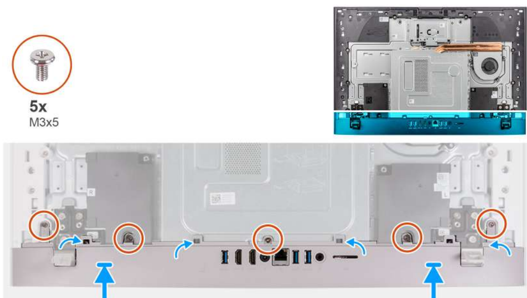
Figura24. Instalar a tampa inferior
