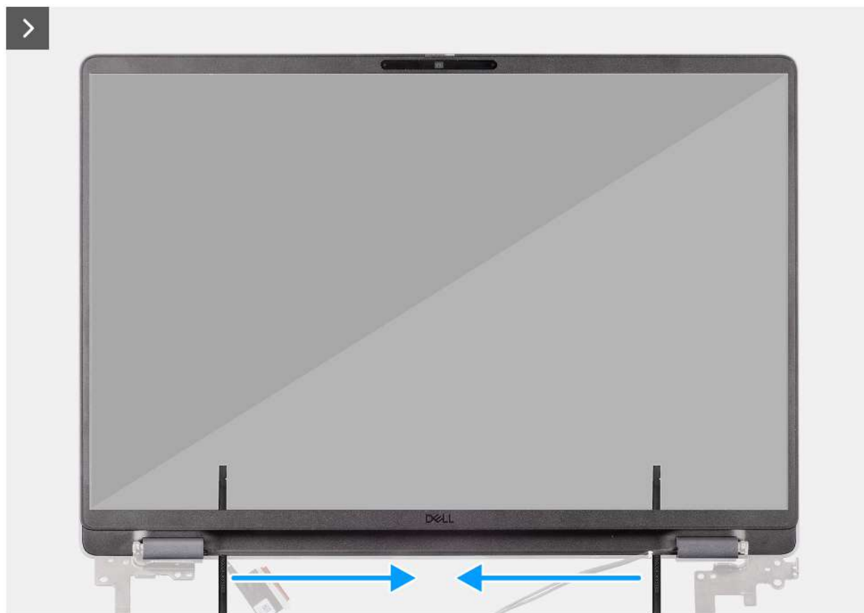
Figura99. Retirar a moldura do ecrã
