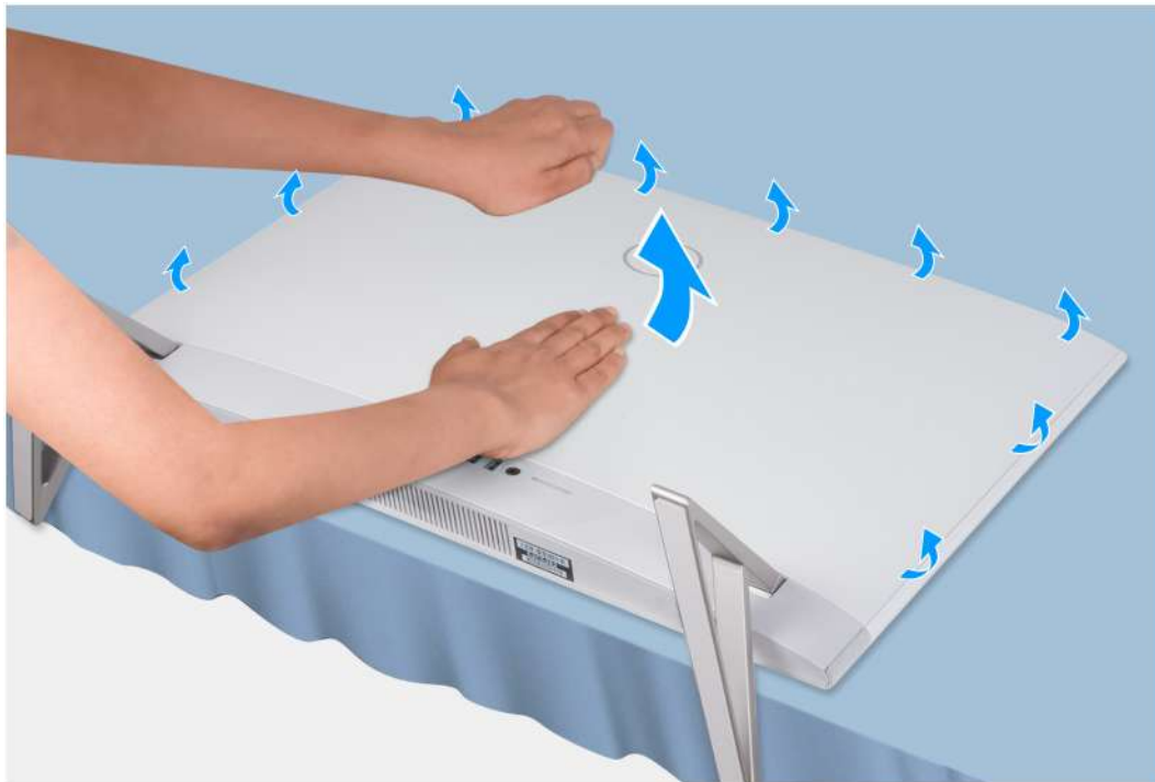
Figura21. Retirar a tampa posterior
