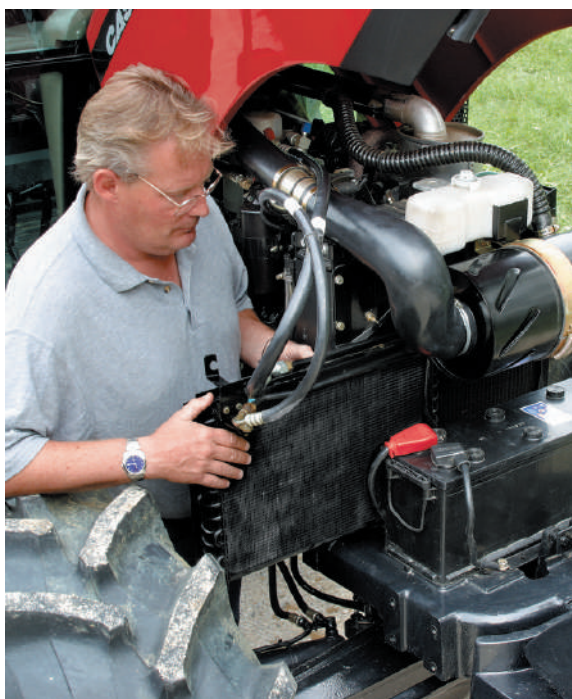
Unidade de condensador removível para facilitar a limpeza.
